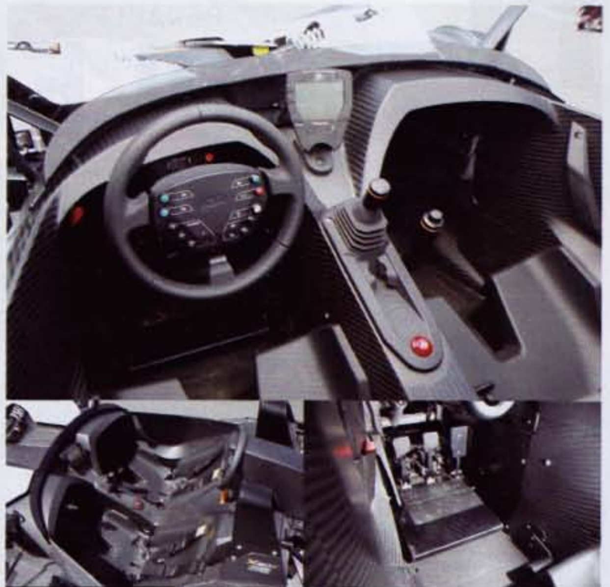
カーボンモノコックそのままの cockpit。シート位置は固定だが、ペダル類がアッセンブリーで前後にスライドする。試乗車は欧州仕様の4点式ベルトを装備していた。バイクから流用した液晶ユニットで速度等を表示し、ライト類のスイッチは脱着式ステアリングのパッドに備わるなど、そのメカニズムも作りも非常に高品質である。
