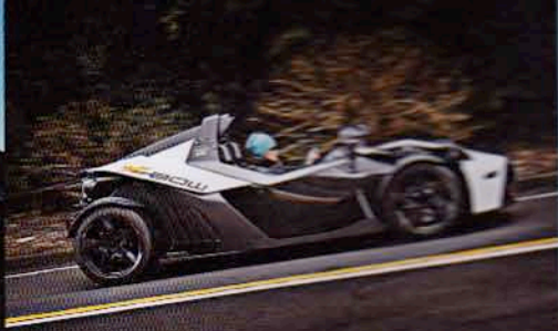
首から下はすっぽりとモノコックに収まる。クラッシュボックス内蔵のカーボンモノコックに包み込まれる安心感はフォーミュラーの cockpit に収まったときのイメージに近い。全長 3738mm × 全高 1915mm × 全幅 1920mm と写真で想像するよりも実物は立派。ボディデザインはザルブルクにあるキスカデザインが担当している。
