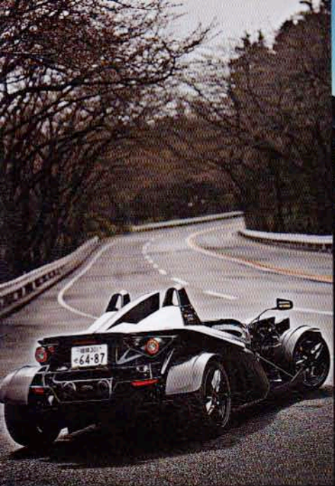
首から下はすっぽりとモノコックに収まる。クラッシュボックス内蔵のカーボンモノコックに包み込まれる安心感はフォーミュラーの cockpit に収まったときのイメージに近い。全長 3738mm × 全高 1915mm × 全幅 1920mm と写真で想像するよりも実物は立派。ボディデザインはザルブルクにあるキスカデザインが担当している。
